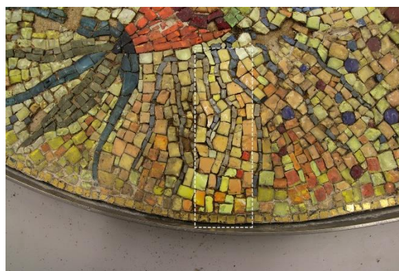
Obr. 42: Průběh odstraňování tmavého povlaku exhalací. Rozšířená zkouška čištění.
