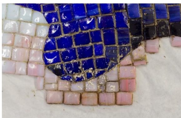
Obr. 17: Residua epoxidového lepidla ve spárách mezi mozaikovými kostkami.
