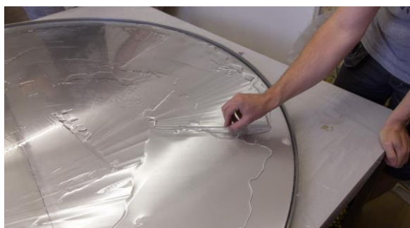
Obr. 32: Průběh roztírání tenké vrstvy epoxidového lepidla po povrchu hliníkové voštinové desky.
