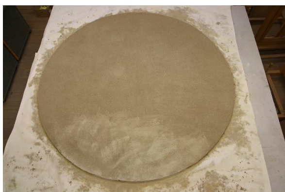
Obr. 25: Celkový pohled na rubovou stranu mozaiky s první vrstvou omítky – z písku a přírodně hydraulického vápna.
